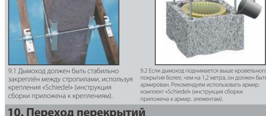
9.1 Дымоход должен быть стабильно закреплен между стропилами, используя крепления «Schiedel» (инструкция сборки приложена к креплениям). 9.2 Если дымоход поднимается выше кровельного покрытия более, чем на 1,2 метра, он должен быть армирован. Рекомендуется использовать армир. комплект «Schiedel» (инструкция сборки приложена к армир. элементам).
