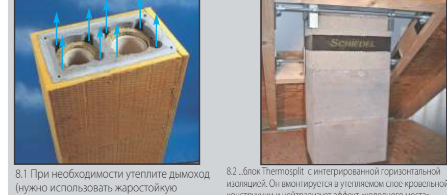
8.1 При необходимости утеплите дымоход (нужно использовать жаростойкую минеральную вату). 8.2 Теплоотраж. с минеральной горизонтальной изоляцией. Он выводится в утепленном слое кровельной конструкции и нейтрализует эффект колпакового моста (дымоход дополнительно армируется).
